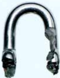
シャックル (SUS304材) ステンレス材単独使用
